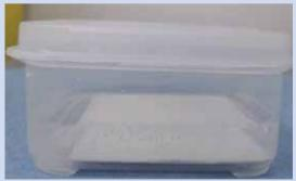
阿鲁克邦®安洁仕具有极强的抗氧化性、耐腐蚀性,市面普及的清洁用剂不会对涂层表面造成损害,便于清洁。 测试方法:将切成5cm×7cm的样品放入PP材质的塑料盒中,倒入要测试的化学品,液面保持在1/2到2/3,放在具有通风条件的恒温箱内测试。
